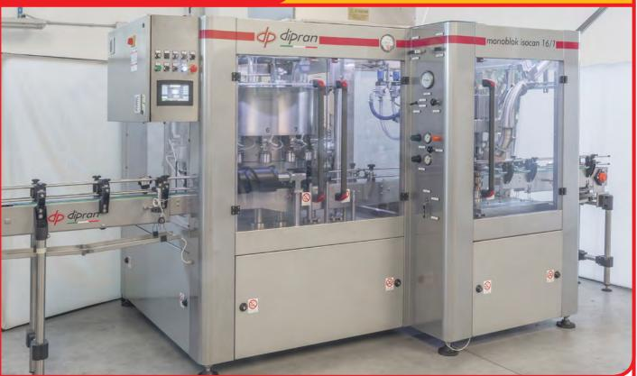
Macchina di tipo meccanica per il riempimento e graffatura di lattine in alluminio. Riempimento di qualsiasi tipo di liquido gassato, sanificabilità totale, manutenzione ridotta,. Grazie al particolare rubinetto e al sistema di regolazione la riempitrice ISO BEER è particolarmente adatta al riempimento di prodotti frizzanti ed in presenza di schiuma.
