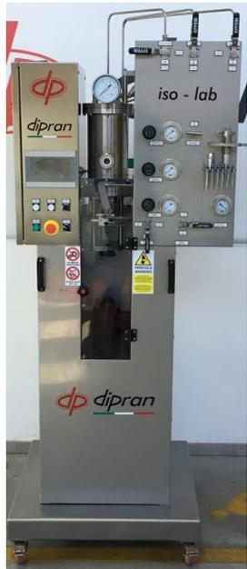
Máquinas especiales realizadas a petición y destinadas a los laboratorios de producción para verificar el resultado final exacto en la producción del producto, sin tener que producir grandes cantidades. Las máquinas pueden suministrarse con enjuagadoras y taponadoras según la exigencias. Utilizadas también para producciones de pequeñas series y para grandes formatos de vinos ( hasta 20lt ). Es posible realizar máquinas para botellas de vidrio, PET y latas.
