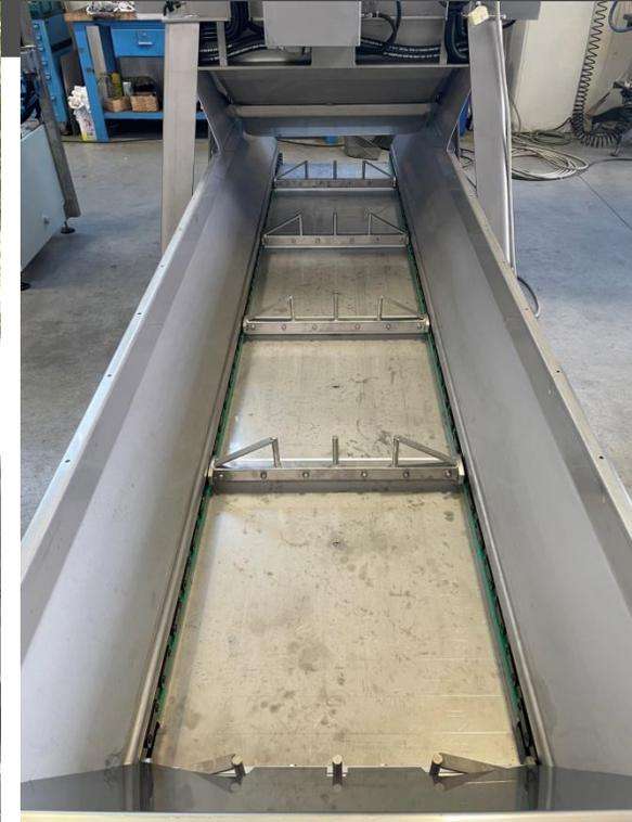
CINTA DE DESCARGA cuando el agave está perfectamente cortado cae en la cinta de descarga debajo y lleva las piezas en las cestas de transporte de corte.
