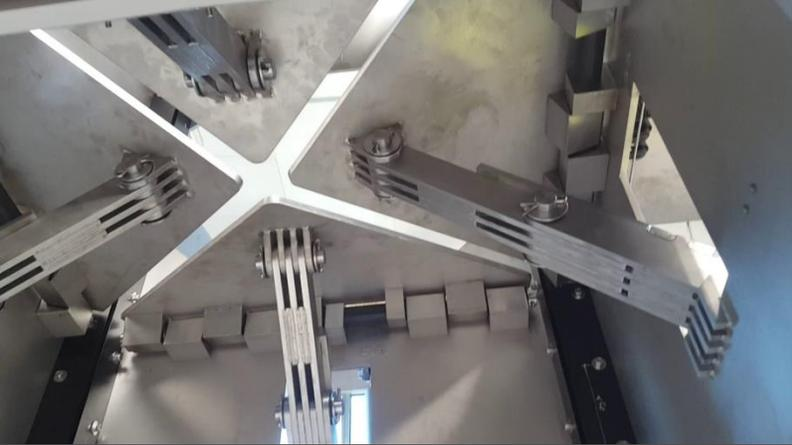
PARTE INFERIOR DE LA MÁQUINA que soporta el agave que pesa hasta 80 kg
