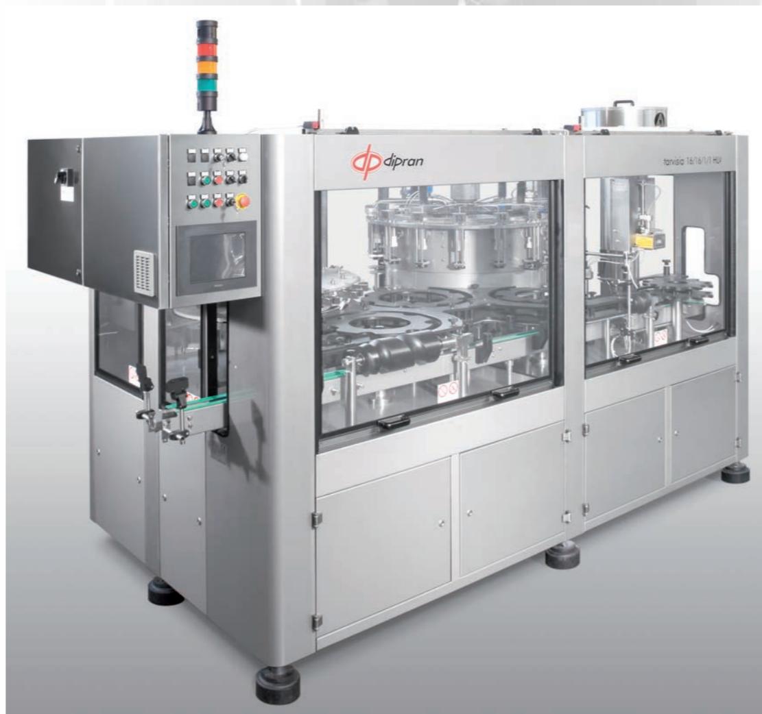
Cornerblok 30 36 6 6 con sistema di presa universale per bottiglie. Non esiste più il cambio formato Cornerblok 30 36 6 6 with system of universal taking for bottles. The formed change doesn't exist anymore Cornerblok 30 36 6 6 con sistema de toma universal por botellas. Ya no existe el cambio formado
