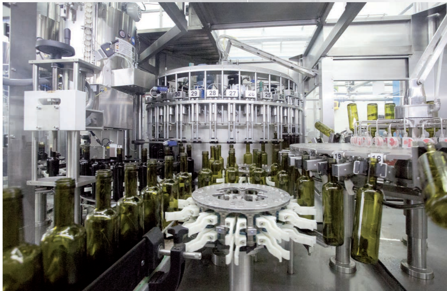
Cornerblok 30 36 6 6 con sistema di presa universale per bottiglie. Non esiste più il cambio formato Cornerblok 30 36 6 6 with system of universal taking for bottles. The formed change doesn't exist anymore Cornerblok 30 36 6 6 con sistema de toma universal por botellas. Ya no existe el cambio formado
